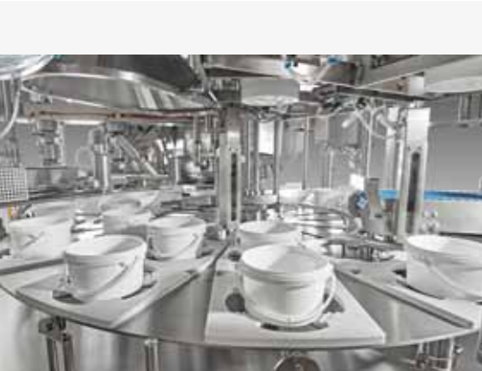
Blick in den 2-bahnigen Drehteller; er ist für Rund- und Rechteck-Eimer ausgelegt
