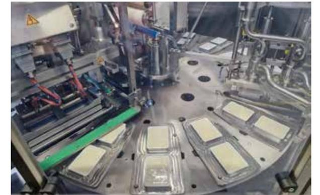
Blick in den Rundläufer bei der Abfüllung von Seidentofu in 400-g-Schalen
