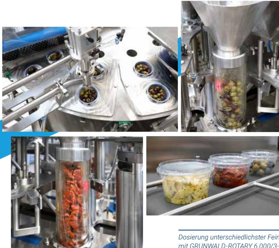
Dosierung unterschiedlichster Feinkostprodukte mit GRUNWALD-ROTARY 6.000/3-bahnig und GRUNWALD-ROTARY 12.000/2-bahnig
