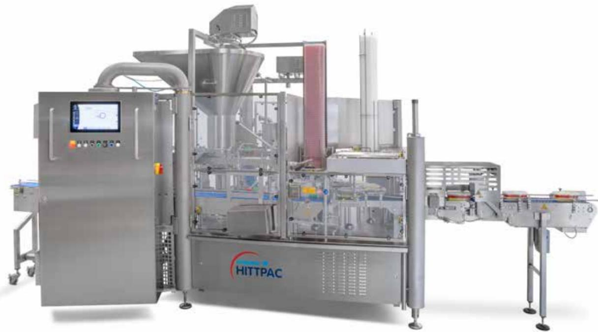
*GRUNWALD-HITTPAC AKH-059/1-bahnig mit mobilen Doseuren für pumpfähige und nicht-pumpfähige Produkte zur Befüllung von Rundeimern und Rechteckschalen*
