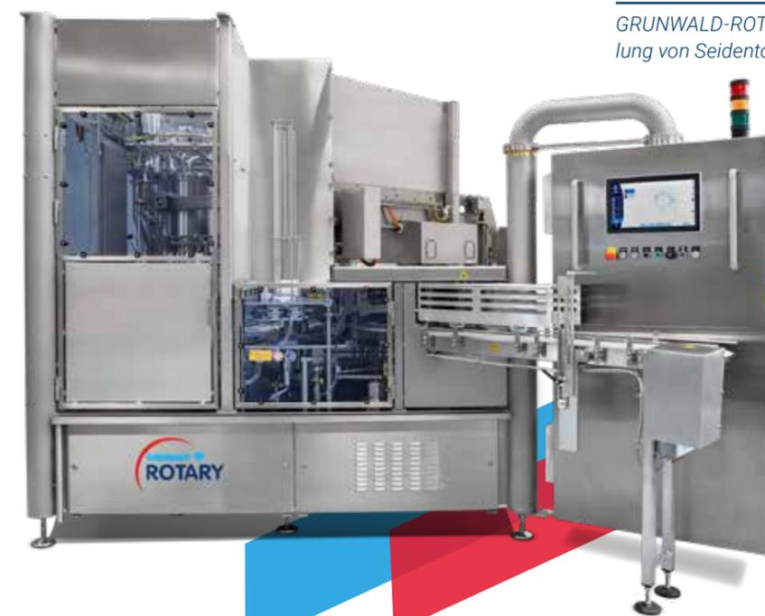
GRUNWALD-ROTARY 20.000/2-bahnig für die Abfüllung von Seidentofu in 400-g-Schalen und 5-kg-Eimer
