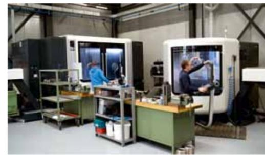
*Auch die im Oktober 2016 gelieferte, 6 m lange und 15 Tonnen schwere Fahrständerfräsmaschine Typ DMF 180 ist in die neue Halle umgezogen. Rechts von ihr die dreiaxige Universalfräsmaschine DMU 60 monoBLOCK®. An den Maschinen arbeiten unsere Mitarbeiter Markus Rehm (links im Bild) und Frank Hofmann.*
