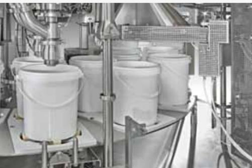
2-bahnige, wiegezellen-gesteuerte Füllstation
