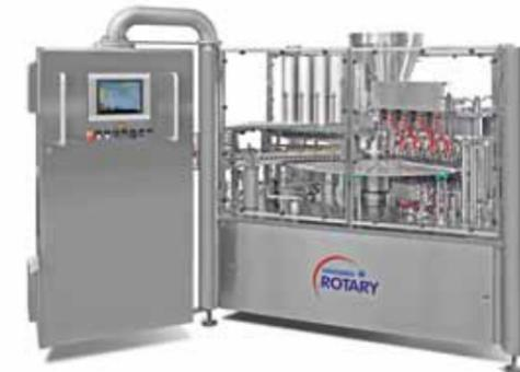
Die Dritte im Trio der Ausstellungsmaschinen bildet die Rundläufer-Eimerabfüllanlage **GRUNWALD-HITPAC XL** für die Abfüllung von flüssigen bis pastösen Produkten in Eimer von 1 kg bis 10 kg.
