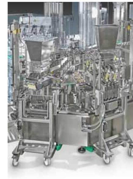
Bei dieser speziell auf diese Anwendung entwickelten Dosieranlage wird nun die Anzahl der zu dosierenden Kichererbsen am Bedienpanel vorgewählt. Die Zahl der dosierten Kichererbsen wird mit einer hinreichenden Genauigkeit erreicht.
