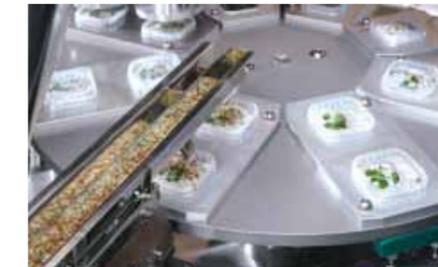
Blick in eine GRUNWALD-Rundläuferanlage mit Garnierstationen für Paprikawürfel (rechts im Bild) und Gewürzmischung (links)
