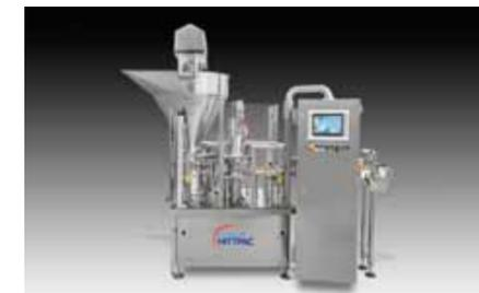
GRUNWALD-Rundläufer zur Abfüllung von Pasten in sterilisierfähige Alu- und Kunststoffbecher
