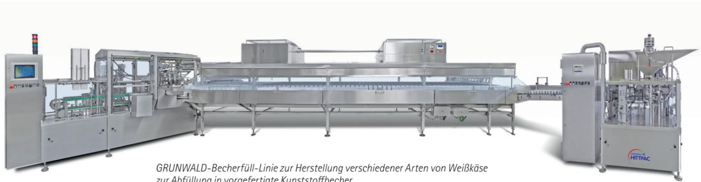
GRUNWALD-Becherfüll-Linie zur Herstellung verschiedener Arten von Weißkäse zur Abfüllung in vorgefertigte Kunststoffbecher. Von links nach rechts die Bereiche Füllen - Koagulieren - Verdeckeln
