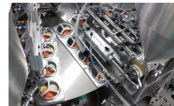
Abfüllung verschiedener Hummusprodukte in 3-Kammerbecher
