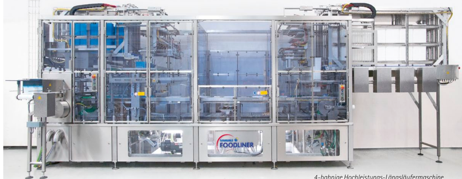
4-bahnige Hochleistungs-Längsläufermaschine GRUNWALD-FOODLINER 6.000 mit Mehrkopfwage für Waschcapseln
