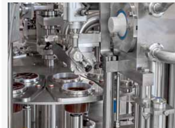
Blick auf den Drehteller der Rundläuferabfüllanlage mit befüllten Bechern vor der Versiegelung
