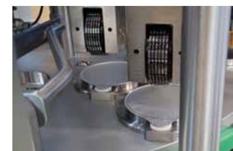
Prägestation zum Eindruck eines Datums
