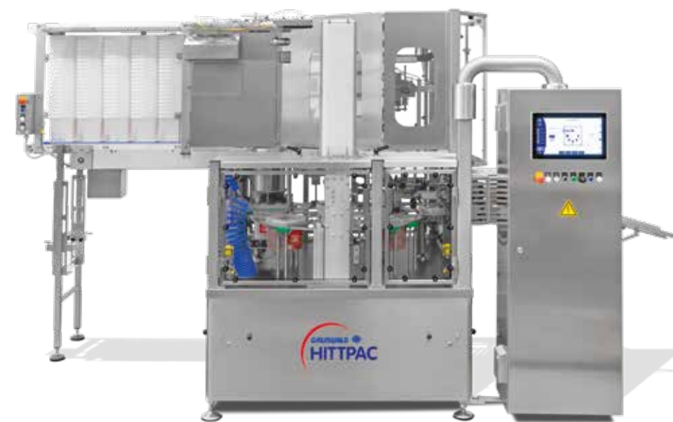
1-bahniger, robust gebauter Rundläufer Becherfüller GRUNWALD-HITPAC AKH-029S der durch einfache Bedienung und schnelle Umrüstung auf verschiedene Produkte und Packstoffe besticht.
