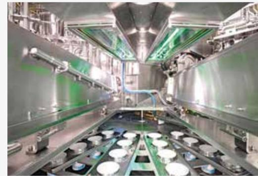
Die Hochleistungsstrahler des zweifach Pulsed-Light-Hochleistungs-UV(C)-Entkeimungsverfahrens im Hygienetunnel des UC-Rundläufer-Becherfüllers
