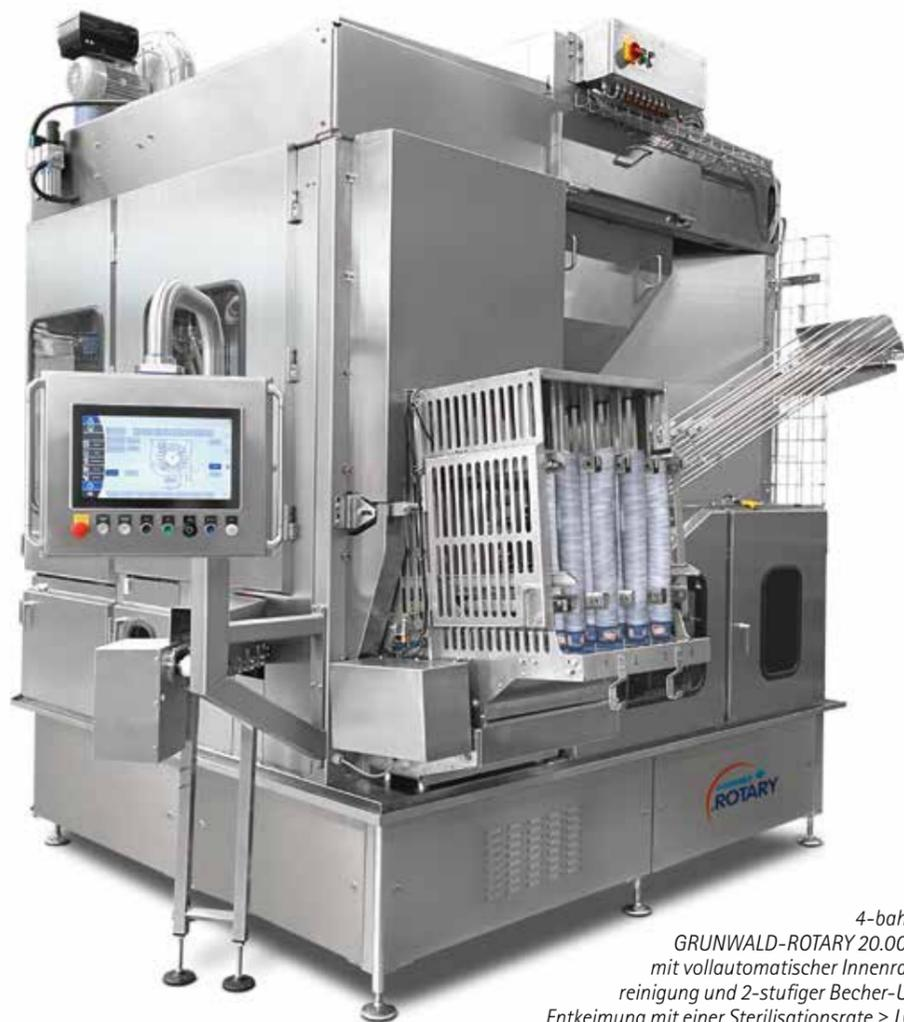
4-bahnige GRUNWALD-ROTARY 20.000UC mit vollautomatischer Innenraumreinigung und 2-stufiger Becher-UV(C) Entkeimung mit einer Sterilisationsrate  $\geq$  LOG 4
