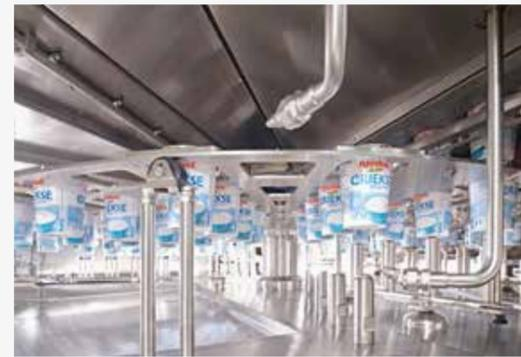
In der Bildmitte eine der Sprühdüsen der vollautomatischen Innenraumreinigung für das Einschäumen und Abspülen des Drehtellers; optionale, ergänzende Ausstattung: komplette Innenraumrocknung mit erwärmter laminarer Luft
