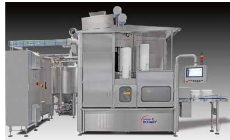
Bucket filler GRUNWALD-ROTARY XL-UC /1-lane.
